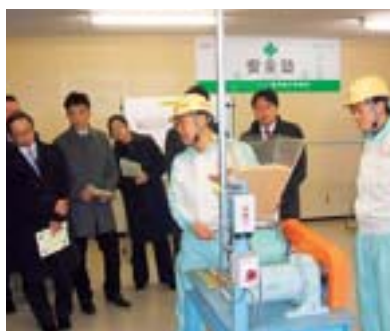
ロータリーバルブの羽根とケーシングへの挟まれを説明
