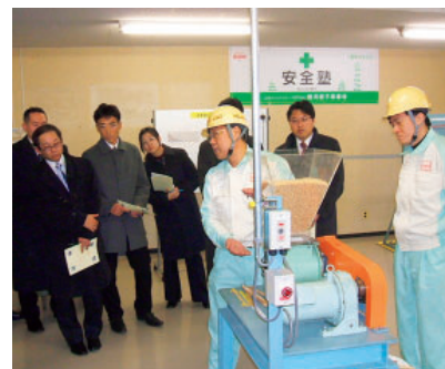
ロータリーバルブの羽根とケーシングへの挟まれを説明
