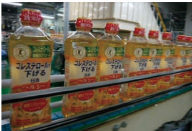
「新600gペットボトル」の充填ライン
