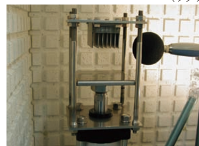
揚げ物を砕く装置と音響センサー
