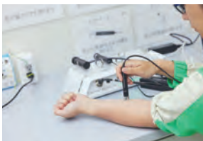
恒温恒湿室内では一定条件下で皮膚測定ができ精緻な評価が可能です
